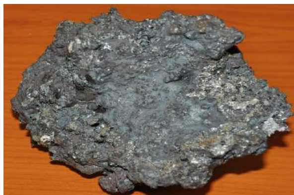
experimentálne vytavená železná huba
